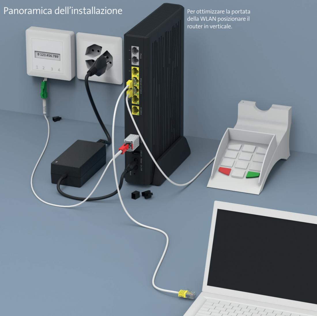
Per ottimizzare la portata della WLAN posizionare il router in verticale.
