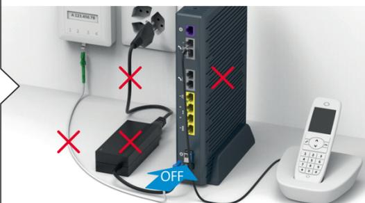
Spegnere il vecchio router, ma rimuoverlo solo una volta messo in funzione il collegamento in fibra ottica.
